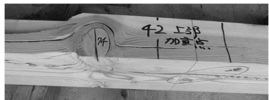
写真 3-10 荷重点外の狭い面の節 (例外)
