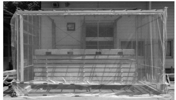
写真 3-2 ガラスハウス乾燥機
