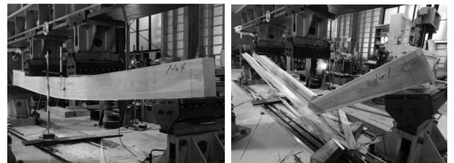
写真 5-5 曲げ強度試験の実施状況
