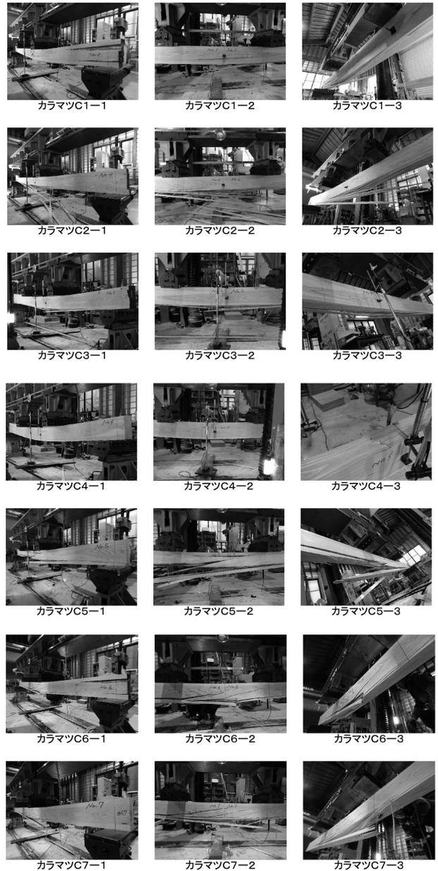
写真 5-8 接着重ね梁Cタイプカラマツの破壊形態
