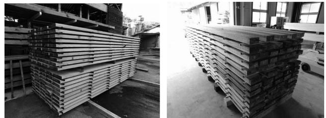
写真5-2 210材木取りからの製材の乾燥
