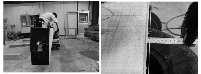
写真 3-6 反り及び曲がり測定状況
