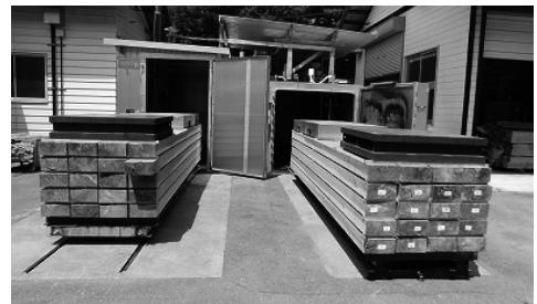
写真 3-2 スギの乾燥前 蒸気式中温乾燥 (左) 蒸気圧力併用式中温乾燥 (右)
