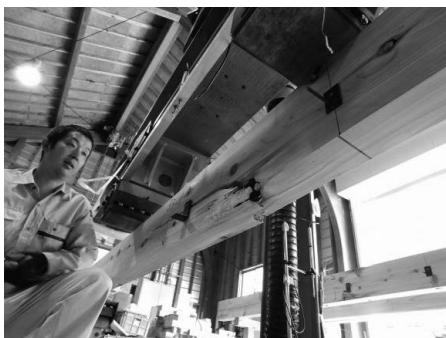
写真 3-13 No. 33-1 の節からの曲げ破壊 (スギ)
