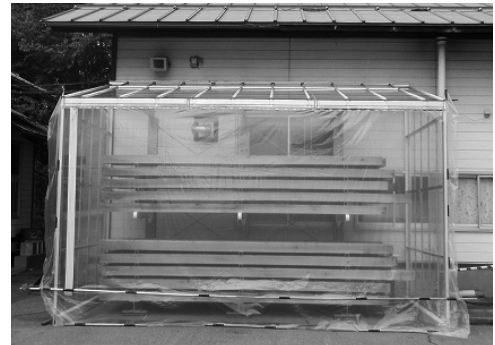
写真 3-3 ガラスハウス内での養生の様子
