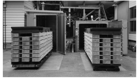
写真 3-1 カラマツの乾燥前 蒸気式中温乾燥 (左) 蒸気圧力併用式中温乾燥 (右)
