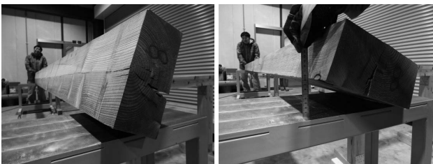
写真 3-7 ねじれ測定状況 (カラマツ)
