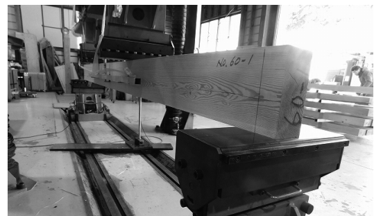
写真3-5 曲げ試験状況
