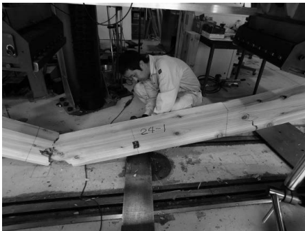
写真 3-12 No. 24-1 の破壊後 (スギ)
