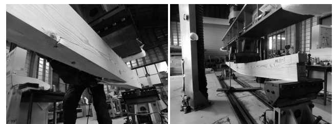
写真 3-10 No. 8-2 の目切れと節による曲げ破壊
