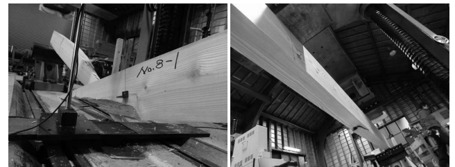
写真 3-8 No. 8-1 の目切れによる曲げ断破壊
