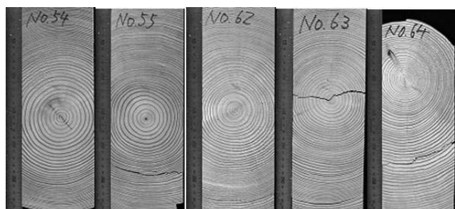
写真2-14 カラマツの断面のスカナー画像
