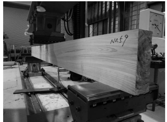
写真 2-3 曲げ試験状況
