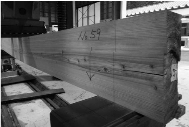
写真 2-12 No. 59 のせん断破壊状況
