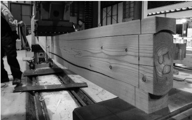
写真2-8 No44 の目まわりとせん断破壊
