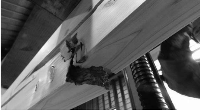
写真 2-11 No. 32 の節からの曲げ破壊
