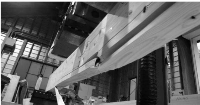
写真 2-13 No. 42 の節からの曲げ破壊状況
