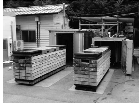
写真2-1 乾燥前の供試材 蒸気式乾燥機(左)、蒸気圧力併用式乾燥機(右)
