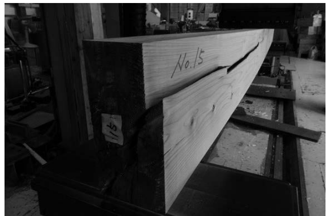
写真2-10 No. 15のせん断破壊
