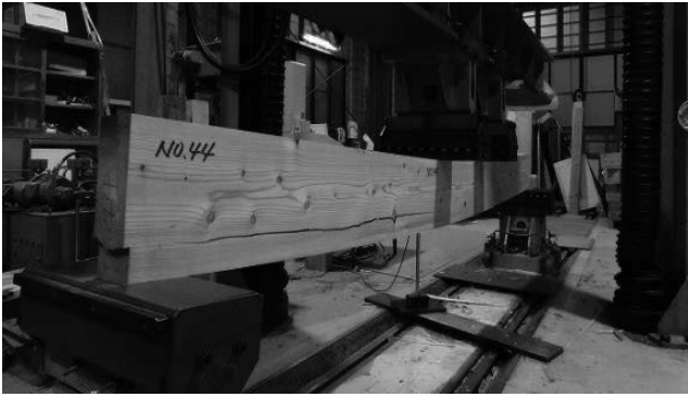
写真2-8 No44 の目まわりとせん断破壊
