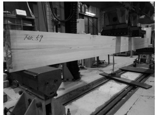
写真 2-4 上部荷重点と下部支点間 (1, 650 mm) (3, 900 mm)
