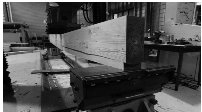
写真2-7 No27の目まわりとせん断破壊
