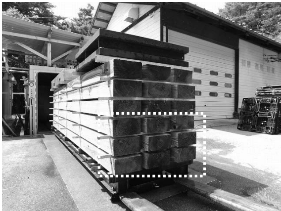
写真-9 蒸気圧力併用型乾燥の様子 (点線枠内の9本が試験体)
