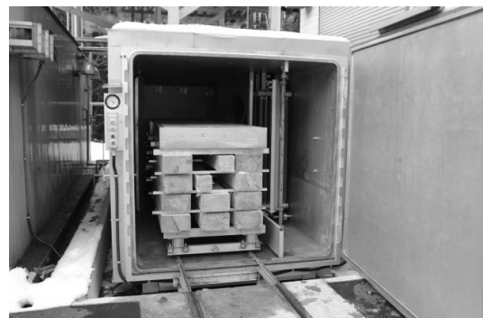
写真-3 蒸気圧力併用型乾燥の様子
