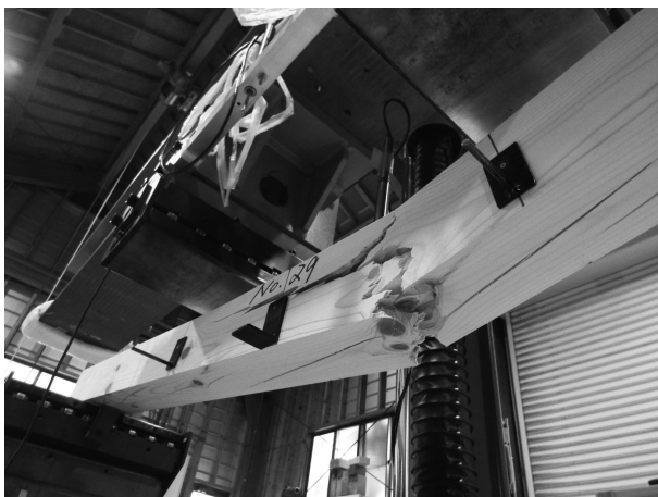
写真-1 節からの曲げ破壊状況
