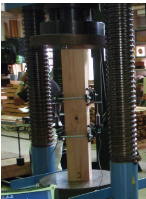
写真-1 圧縮試験の状況
