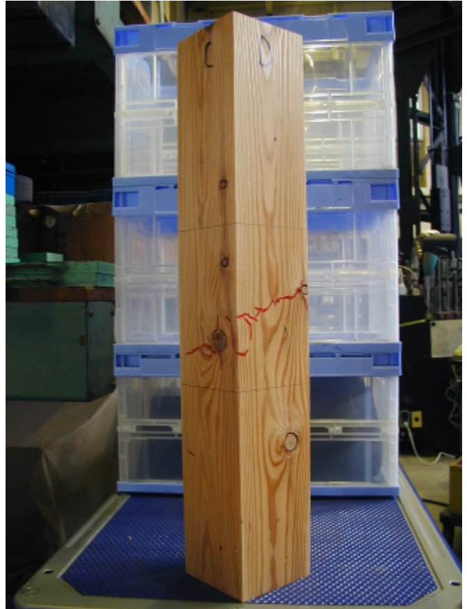
写真-3 カラマツグループC (高温乾燥材) 試験後
