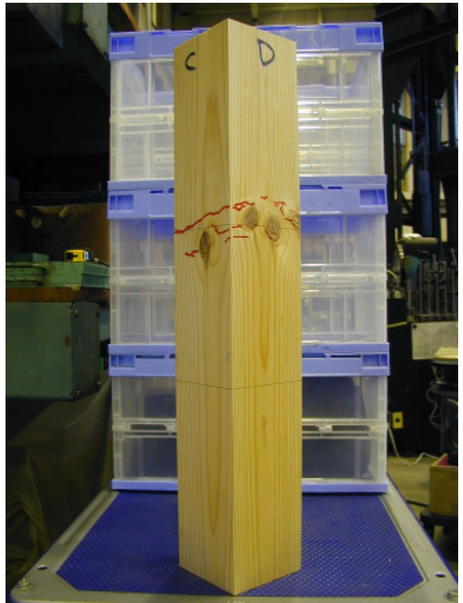
写真-5 アカマツグループC (高温乾燥材) 試験後
