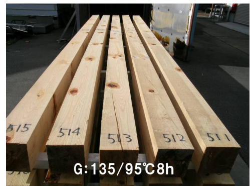
写真-3 材面割れの様子 (アカマツ)
