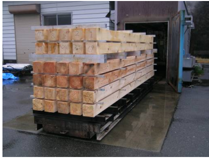
写真-1 蒸気式高温乾燥装置での高温セット 下2段：アカマツ 中2段：カラマツ (上2段：ヒバ)
