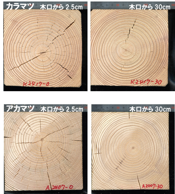
写真-2 同一材における内部割れ発生の様子（例） （高温セット 24 時間）
