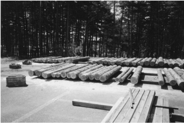
写真-2 供試丸太と両木口からの円板の採取
