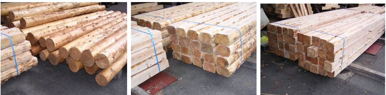
写真-2.1 曲げ強度試験前の試験材（左から丸太材，たいこ材，角材）
