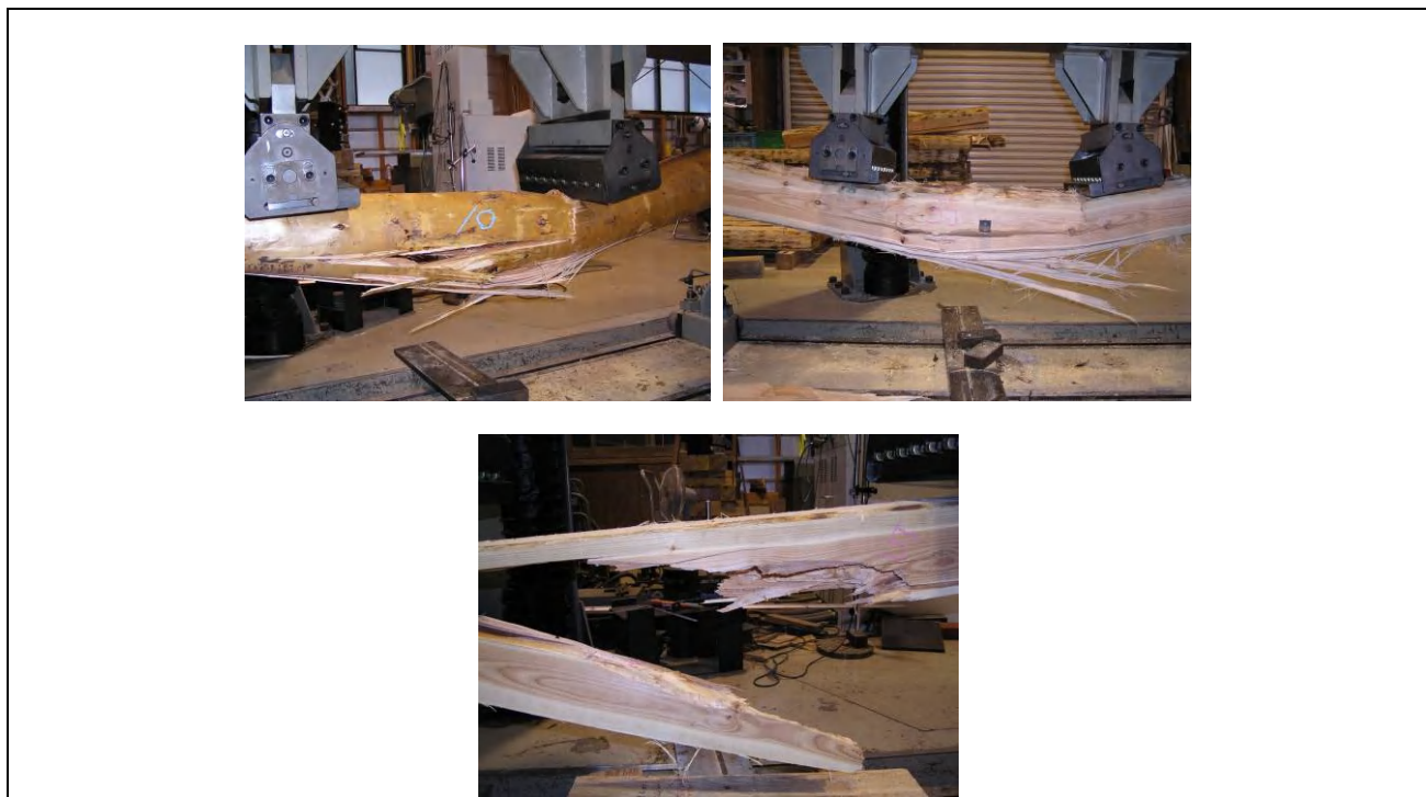
写真-2.2 曲げ強度試験による破壊部分（左上から下に、丸太、タイコ梁、角）
