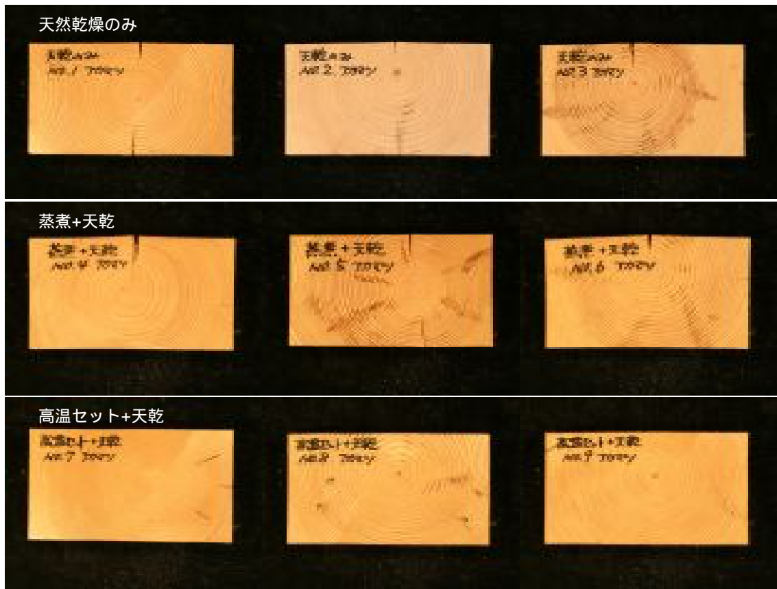
写真9 アカマツ桁材：乾燥後の切断した木口の様子 (上：天然乾燥のみ、中：蒸煮+天乾、下：高温セット+天乾)
