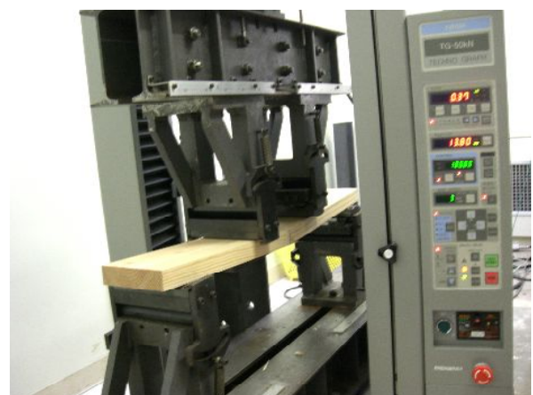
写真 2-1 ラミナの曲げ試験
