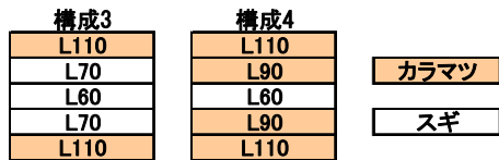
図 3-2 集成材のラミナ構成(めり込み, せん断試験用) ラミナの等級区分は MOE_{AVG} で行い, 試験は平成 18 年度に実施した。
