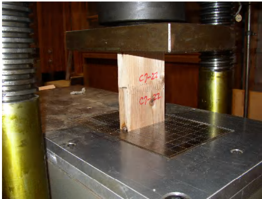
写真 2-3 ラミナの圧縮試験
