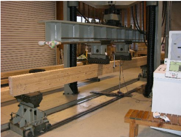
写真 3-1 集成材の曲げ試験
