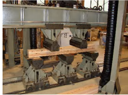
写真 3-9 5点曲げせん断試験
