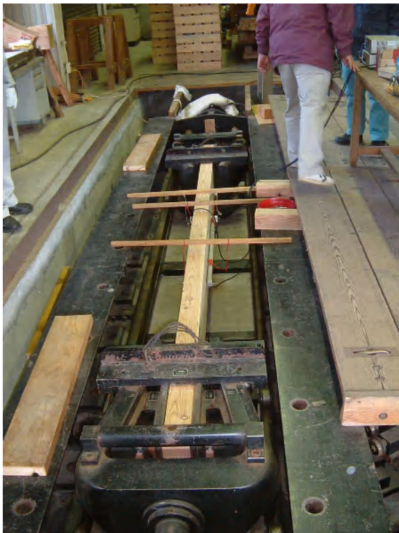
写真 3-2 集成材の引張り試験全景
