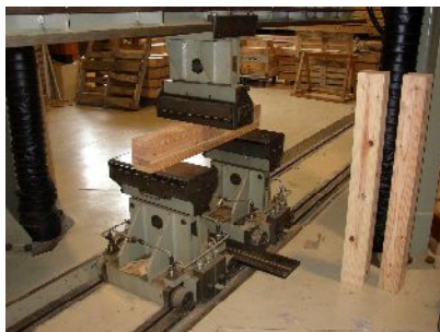
写真 3-8 3点曲げせん断試験
