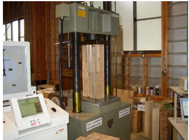
写真 3-4 集成材の圧縮試験
