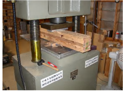
写真 3-5 むり込み試験(縦使い)
