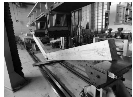
写真-1 曲げ強度試験の様子
