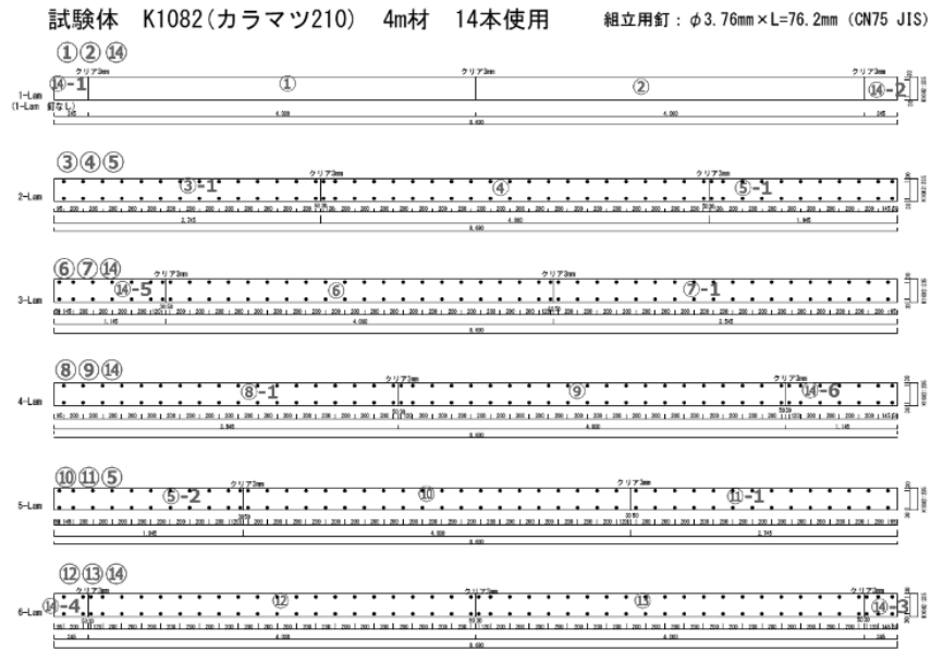
図-2 試験体の構成及び試験体素材の割付
