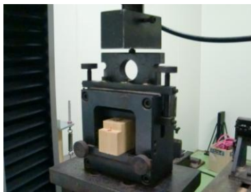
写真 ブロックせん断試験の様子
