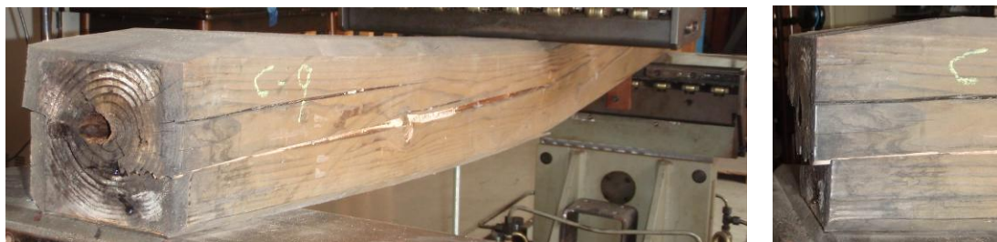
写真-4 材面割れから生じた2号型部材のせん断破壊
