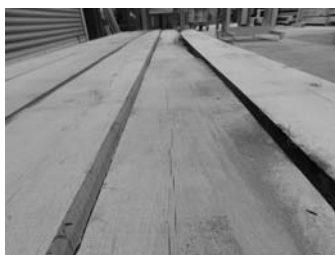
写真-4 乾燥後の試験片、割れの状況
