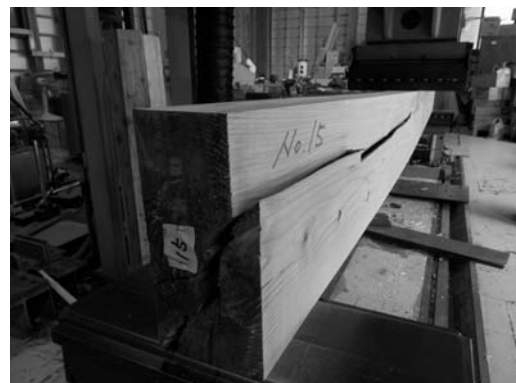
写真-4 スギ No15 の目まわりとせん断破壊
