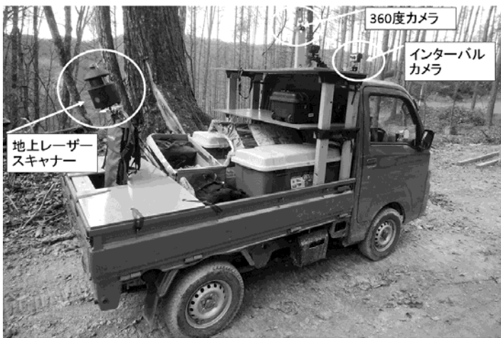
図-1 製作した MMS 試作機
