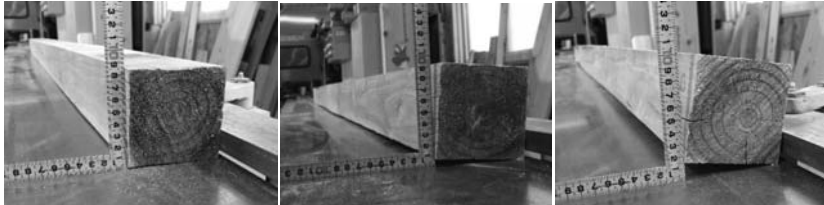
写真 2 8.5 cm 正角材のねじれの様子 （左：最小 3 mm、中央：平均 8 mm、右：最大 14 mm）
