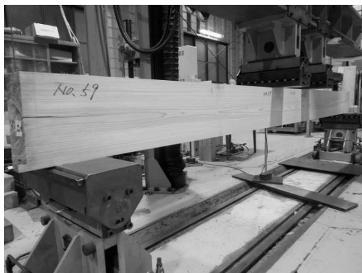
写真-1 曲げ試験状況
