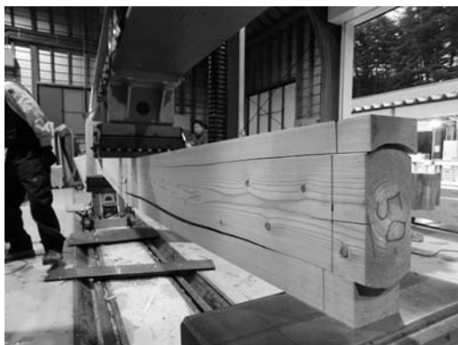
写真-3 カラマツ No50 の目まわりとせん断破壊
