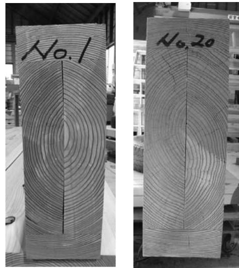
写真 調湿後の断面の変形状態
