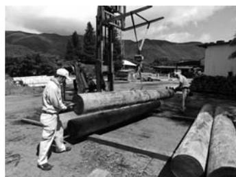
写真 2 丸太動的ヤング係数の測定
