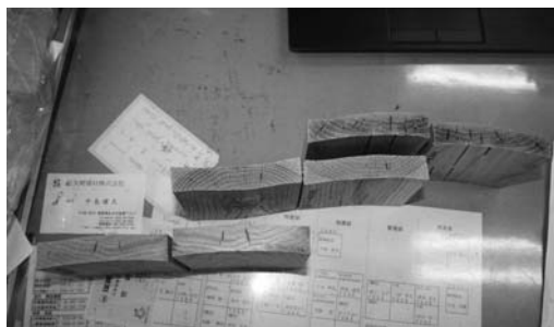
写真1 100℃急速乾燥試験断面変形
