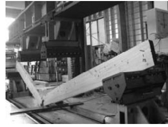
写真-1 中心エレメント曲げ試験 (エッジワイズ)
