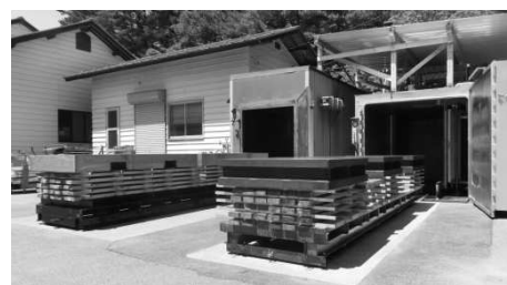
写真1 試験を行った乾燥装置 （左：蒸気式乾燥機、右：蒸気・圧力併用乾燥機）
