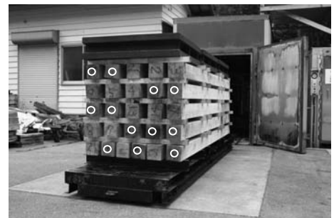
写真 1 乾燥機内の乾燥材の積み重ねの様子 （白丸：心持ち材）
