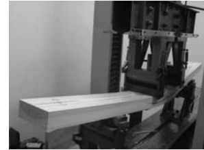
写真-2 外層エレメント曲げ試験 (フラットワイズ)
