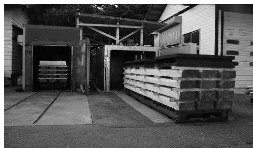
写真 2 乾燥の様子 左：蒸気式中温乾燥 12 本 右：蒸気・圧力併用型乾燥 12 本
