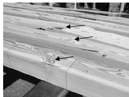
写真 2 曲げ強度試験後の様子 (引張側) (節からの破壊がほとんど)
