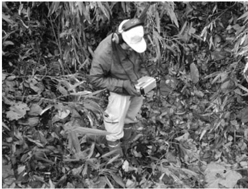
写真 地下流水音探査
