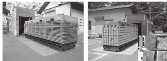
写真-8 ねじれ抑制のため木材乾燥時に重石を載せる (板材の乾燥では効果が大きい(左)、角材の乾燥ではなかなかねじれは抑えられない。)
