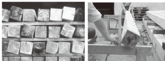
写真-3 乾燥によって生じたねじれ （左：カラマツ、右：アカマツ）
