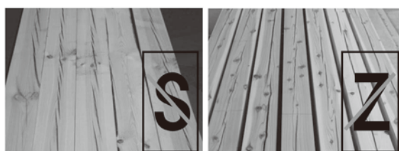
写真-6 繊維傾斜の方向は材面割れの方向とほぼ一致 (左:アカマツ=S旋回、右:スギ=Z旋回) 両者のねじれる方向は逆である
