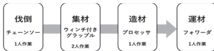
図-5 作業システム
