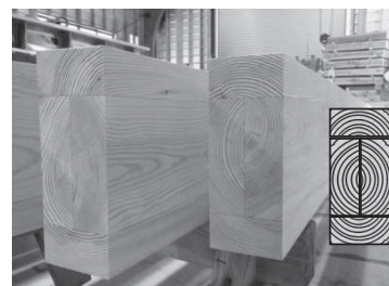
写真-11 高樹齢材から製材した平割を利用した高強度接着重ね梁
