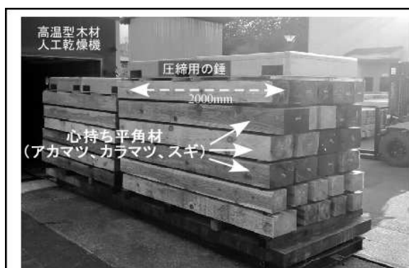
写真1. 針葉樹心持ち平角材の高温セット処理試験
