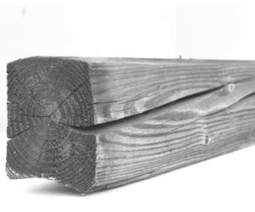
写真-4 20年経過時の最上段の木製遮音板断面 （左）とカラマツ製部材表面の割れ（右）
