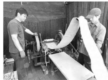
木製トレイへの加工は、森林総研が保有する庄内鉄工（株）製のSMT-0250を使用した（写真-10）。トレイ製造の流れは、①金型に合わせるため、材料をハサミ等で成形する。②蒸射装置の金型に材料を設置し、開始ボタンを押す。③蒸射された材料を取り出し、成形装置の下部金型の上に設置する。④プレス開始ボタンを両手で押し、設定された動作時間及びプレス回数を装置が自動で実施する。（写真-11）⑥成形装置が停止したら材料を取り出すとトレイの形に成型される。なお、金型はスーパーに置いてあるプラスチック製のトレイと同じ型（幅160mm、長さ230mm、深さ20mm）を使用し、成形時の加熱温度は160℃固定とした。
