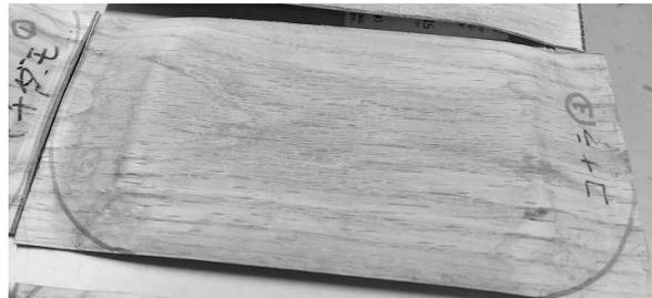
写真-13 製材品のトレイ成形後
