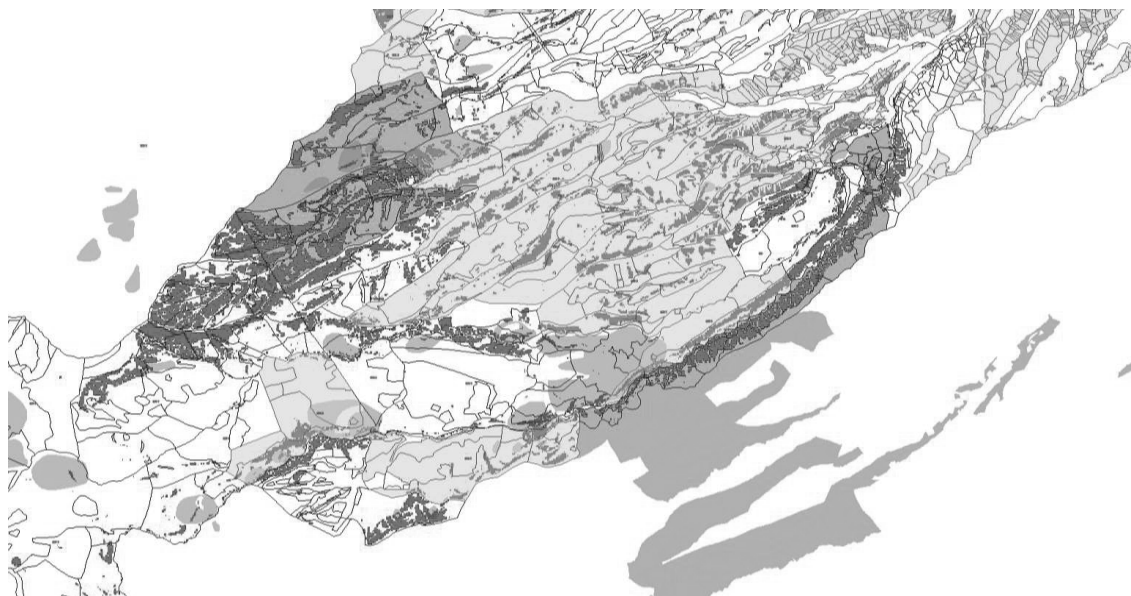
図3 森林情報解析の結果を重ねて絞り込み（地すべりや山腹崩壊危険地との重なりを確認）
