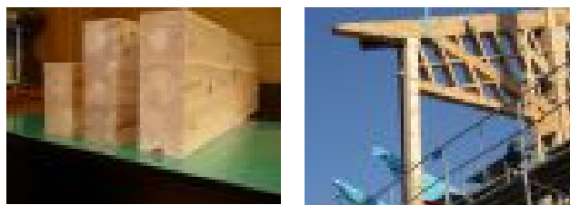
写真-7 接着重ね梁とそれを使用した体育館骨組
