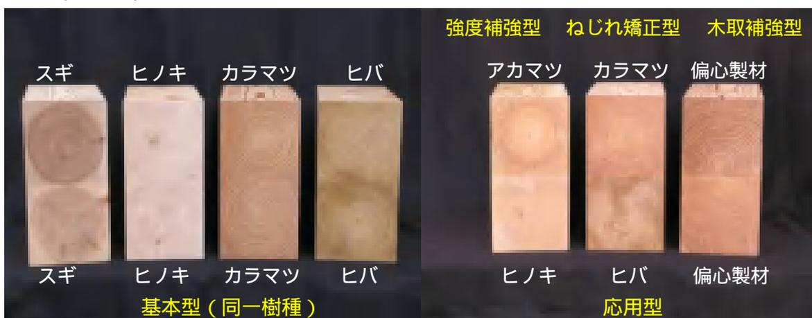
写真-1 研究の対象とした各種接着重ね梁(右端の木取補強型は除く)
