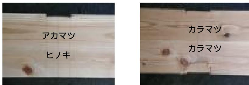
写真-3 密度の違いによるめり込みの様子 (破壊後)
