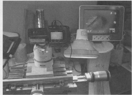
図6 測定顕微鏡による切断後のスライスのピン間距離の測定
