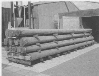
乾燥後のスギ丸太材 (末口32cm、長さ9m)
