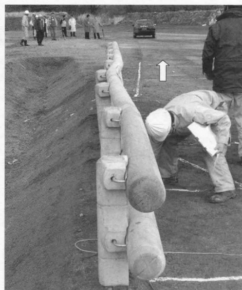
写真-2 実車衝突実験の合格例（左：大型貨物車、右：乗用車、矢印：車両の進行方向）
