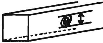
図-2 節の測定法
