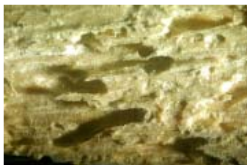
写真 - 4 被害材の材内状況
