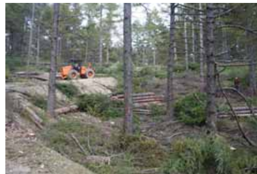
写真.2 県立自然公園内での搬出間伐作業 自然環境を保全するため、森林作業道を配置して動線 規制し、林内への車両進入を行わない作業システムを 採用。木寄せ・集材及び造材は森林作業道上（路体敷） のみで実施した。
