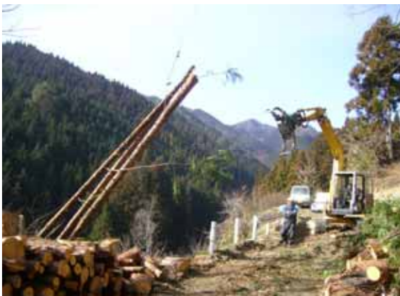
写真6-4 基幹路網を作業ヤードとした架線集材
