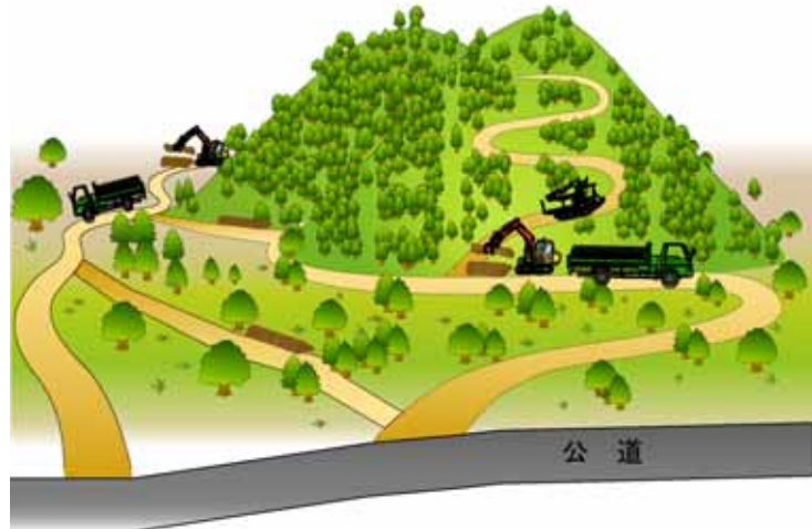
図 6-17 幹線(林業専用道主体)作業システム模式図 土場(集積場)を設けず、集搬のフォワーダ運搬距離を最短として、造材した木材を路線沿いから直接 6~10t 級トラックに積み込み、市場へと搬送するシステム。
