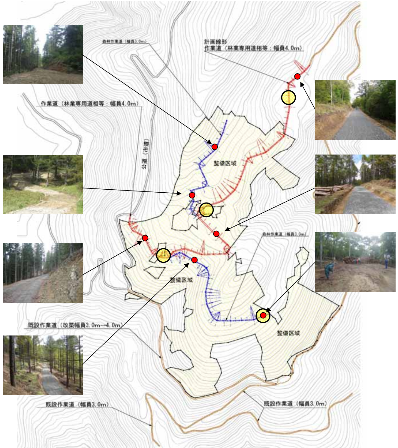
図 6-16 基幹路線の配置事例（写真 6-1 の路線）
