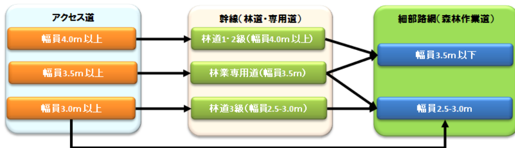
図 6-10 アクセス道の幅員と林内路網の幅員の関係
