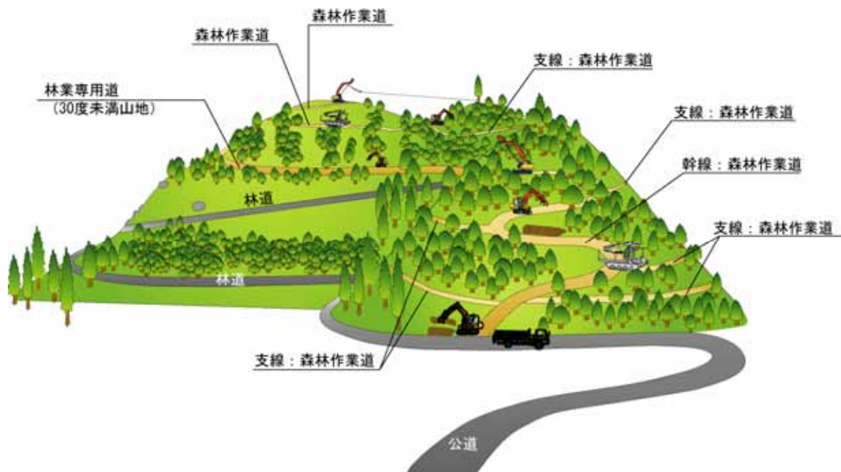
図 6-21 森林作業道の路線線形の模式図
