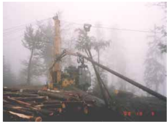
写真6-5 欧州におけるタワーヤード集材 中型タワーヤードによるヨーロッパパトウヒ林分の集材状況。作業ヤードは尾根筋に配置した支線道路上で、上げ荷集材を行っている。 （オーストリア、ザルツブルグ：2000年撮影）
