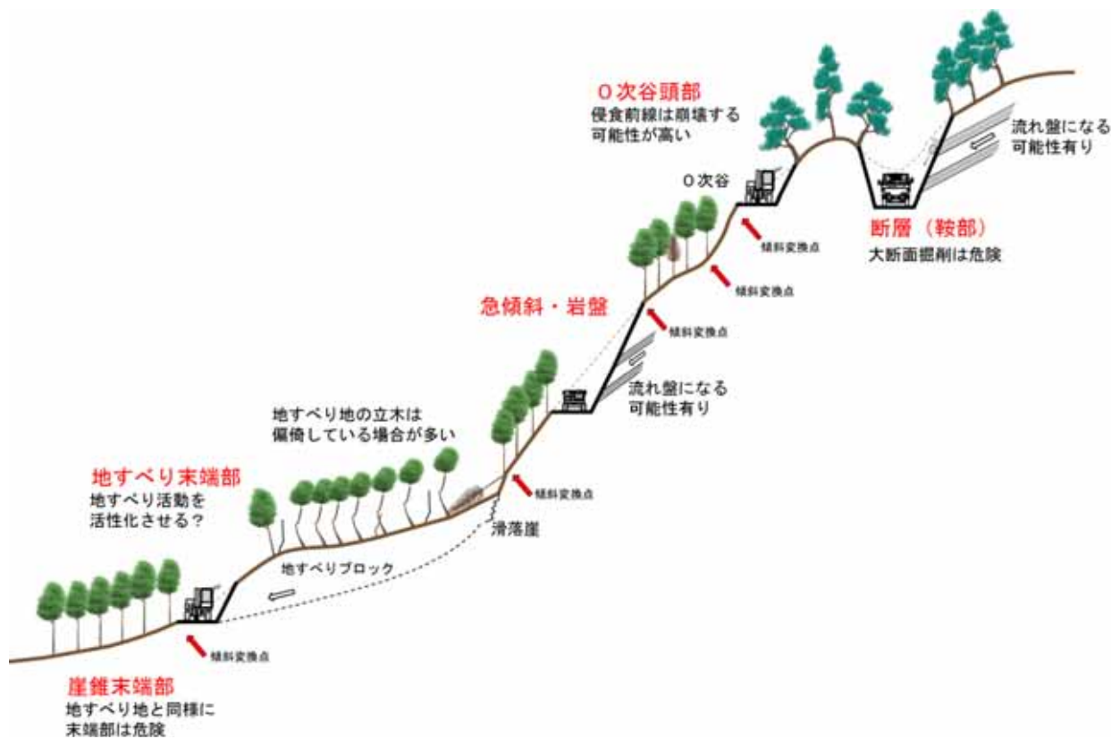
図 5-29 路網配置を回避すべき地形（模式図）
