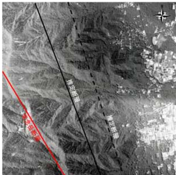
図 5-48 空中写真から読み取れるリニアメント 確認されている常念岳断層と明瞭な地形変移を伴う推定断層（調査により断層破碎帯を確認）。西側を通る常念岳断層が顕著な地形変位を引き起こしており、稜線を境とした極端な非対称山稜となっている。この地形変移は断層によるものと考えられる。常念岳断層は西に約 20 度傾いた走行を持つが、東側（平地側）にはこれに平行なリニアメントが認められる。これらリニアメントは尾根あるいは沢の屈曲や鞍部の連続、地形面の傾斜の変換線が連続するなど顕著に地形を変位させており、多くの断層が潜在していることが推察される。
