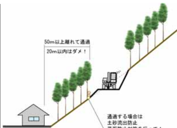
図 5-35 人家裏斜面の路線通過模式図
