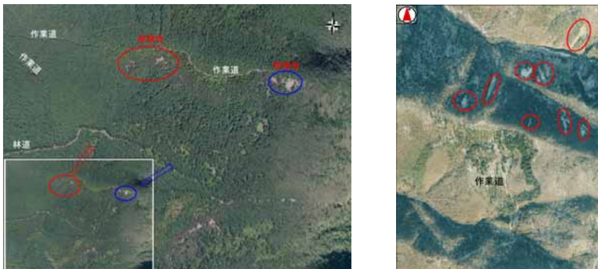
図 5-47 空中写真による崩壊地等の判読の例（左：原村、右：伊那市長谷）
