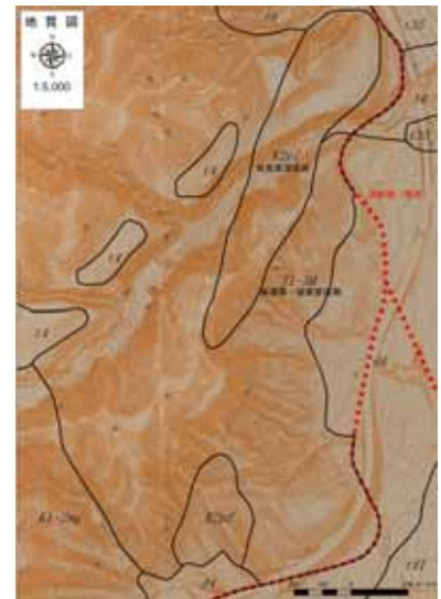
図 5-28 1m メッシュ DEM を用いた地形・地質図 GIS を用いて、数値地図 1m メッシュ DEM と地質図( 富樫編図 ) により作成した地質立体図。( 作成 : 県林業総合センター戸田堅一郎 )
