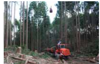
花崗岩地帯の森林作業道と架線系を用いた作業システム
