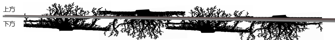
図4-6 根株の盛土法尻への互い違いの設置模式図（断面的）
