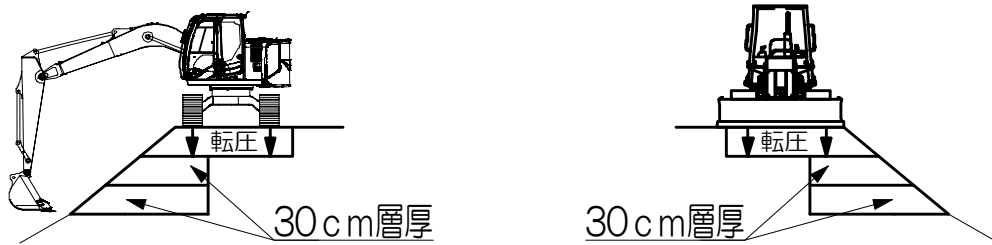
図 4-20 締固め模式図
