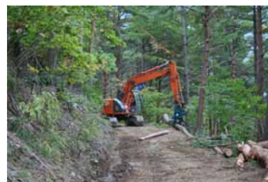
写真 4-66 森林作業道上でのロギングトラクタによる集材とグラブによる木寄せ作業 ロギングトラクタは路肩部までタイヤが張り出す。強固な路肩でないと安全に作業ができない。
