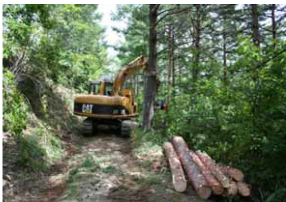
写真 4-9 作業空間は作業効率に影響（左：0.45 級ハーベスタ、右：フォワーダ積載）
