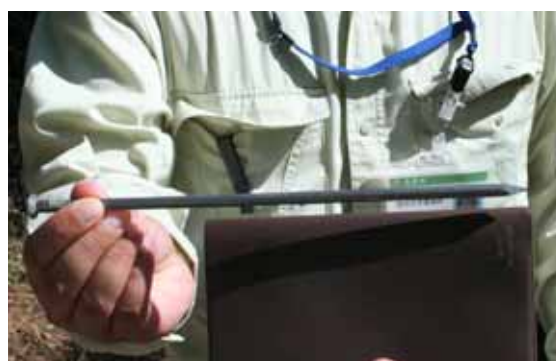
写真4-55 丸太構造物部材連結に用いる釘の状況 （左：釘を用いた連結、右：この現場に用いた規格外特注釘）
