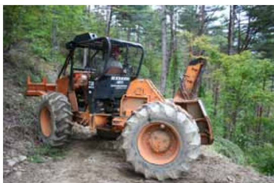
写真 4-66 森林作業道上でのロギングトラクタによる集材とグラブによる木寄せ作業 ロギングトラクタは路肩部までタイヤが張り出す。強固な路肩でないと安全に作業ができない。
