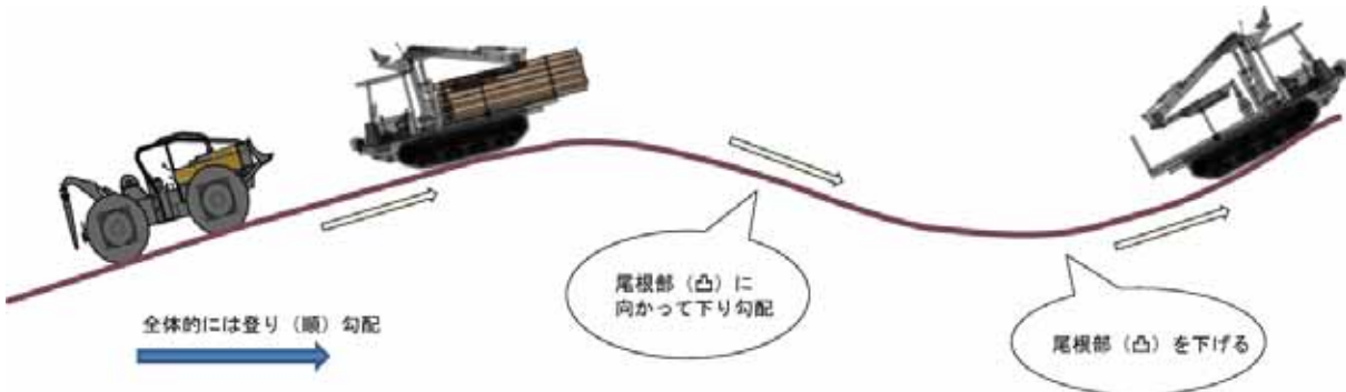
図 1-22 波形縦断線形の模式図
