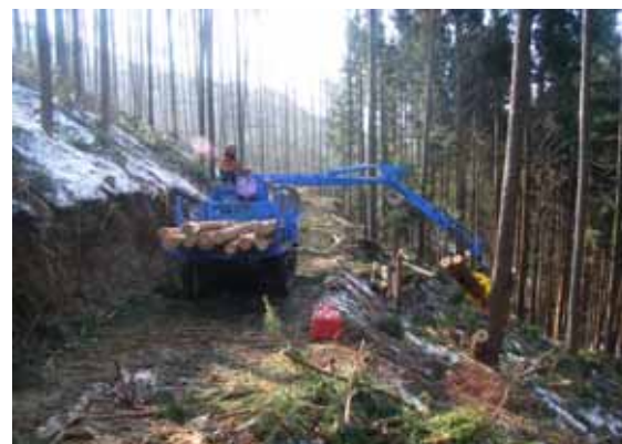
写真 4-9 作業空間は作業効率に影響（左：0.45 級ハーベスタ、右：フォワーダ積載）
