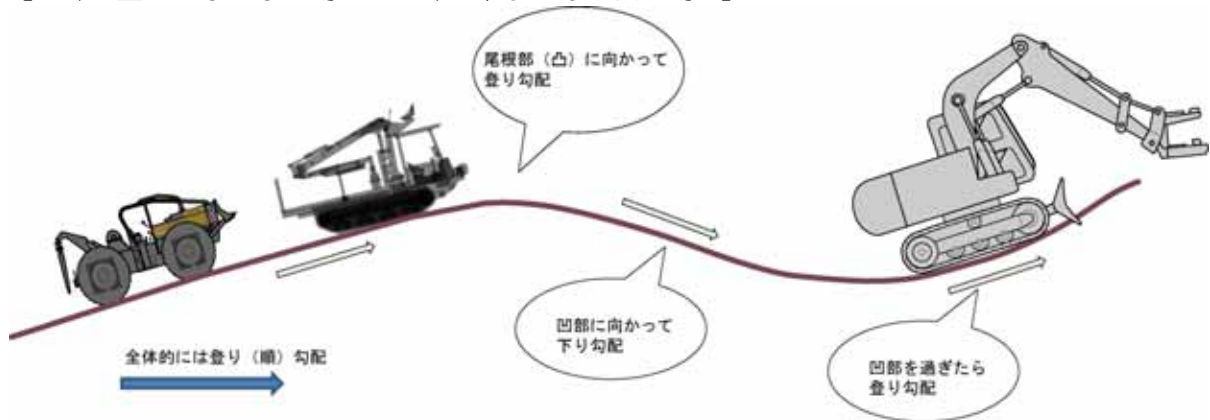
【凹部が盛土となる場合・・・尾根部を下げる波形線形】
