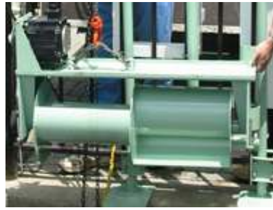
サボニウス水車2号機 (都留市家中川:H16) 100W
