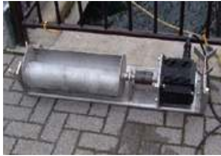
サボニウス水車1号機 (都留市家中川:H15) 40W
