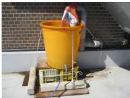
廃材を利用した雨水タンク
