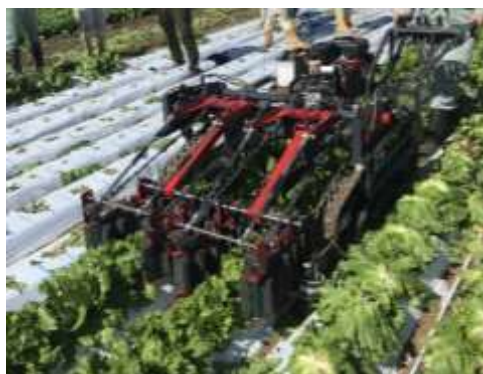
【完成したレタス収穫機（プロトタイプ）】
