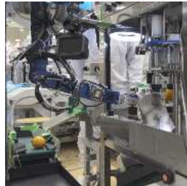
【開発中の柿ロボット（試作機）】
