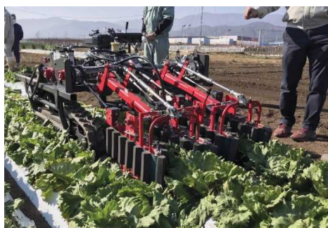
【開発中のレタス収穫機（試作機）】
