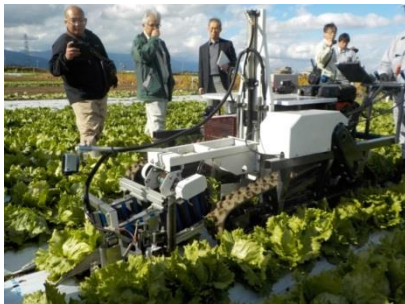
【開発中のレタス収穫機（試作機）】
