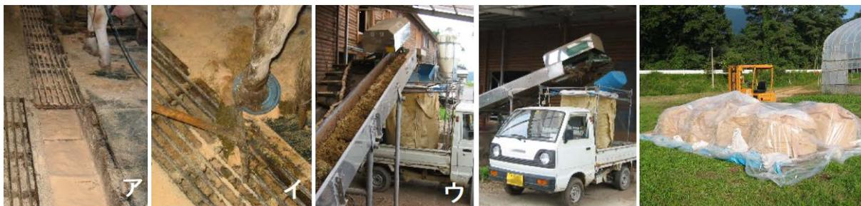
写真 バークリーナーを利用した原料の調整と投入方法及び野外での保管方法
