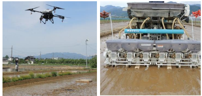
農業用ドローン（左）、乗用播種機（右）を用いた水稲種子の播種作業
