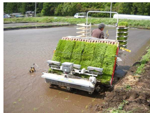
図2 移植と同時に苗箱施用剤、及び除草剤の処理を行っている事例
