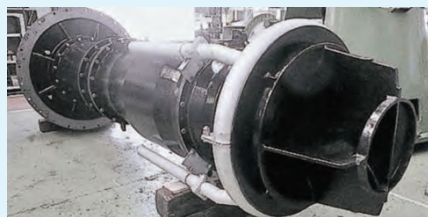
吸入効率を高める渦流防止構造付ポンプ (牛島機場)
