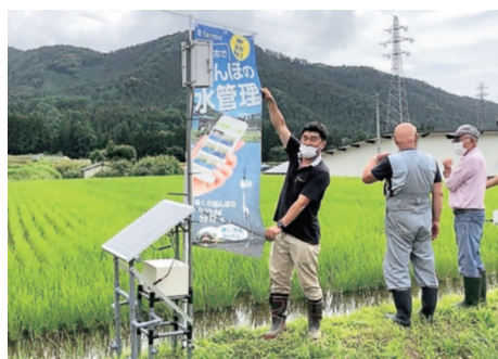
スマホで水管理が可能な自動給水栓の試験設置
