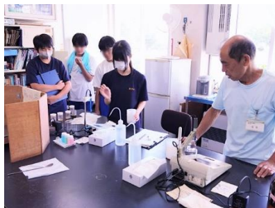
土壌pHやEC（電気伝導度）の測定
