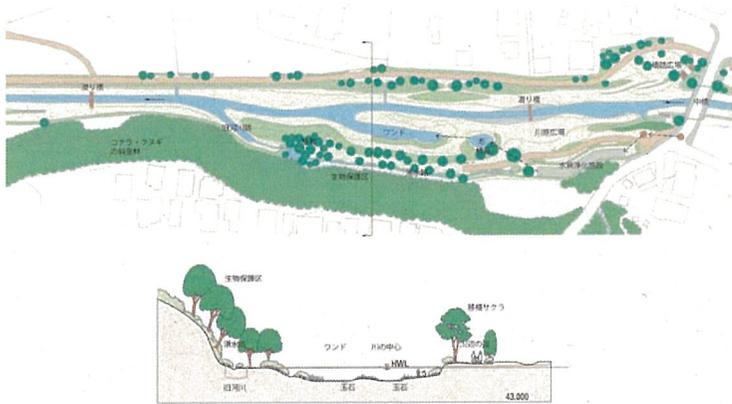
図3 関ヶ原の水辺の平面図と代表横断面。模型から詳細検討を行い図面を起こした。
