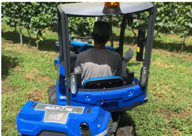
写真1 小回りの利く中折れ構造
