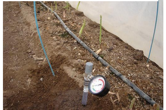
写真2 pFメータによる土壤水分測定
