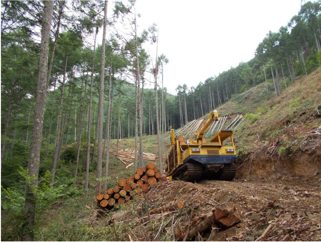
佐久穂町 カラマツ フォワーダ（運搬用高性能林業機械）による運搬状況 伐採現場から山土場（トラックに積み替えるための伐採木の集積所）まで運搬する
