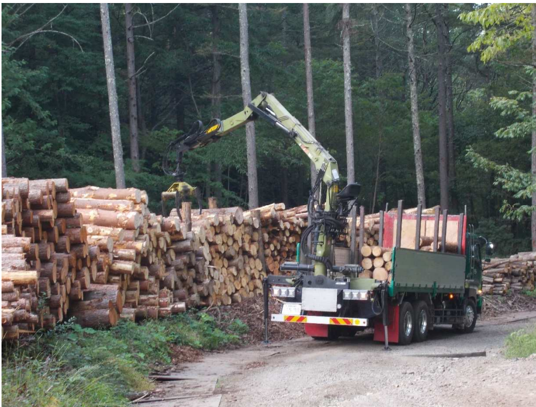
佐久穂町 カラマツ グラップル付きトラックによる積み込み状況 山土場から市場、製材工場、合板工場などへ運搬する
