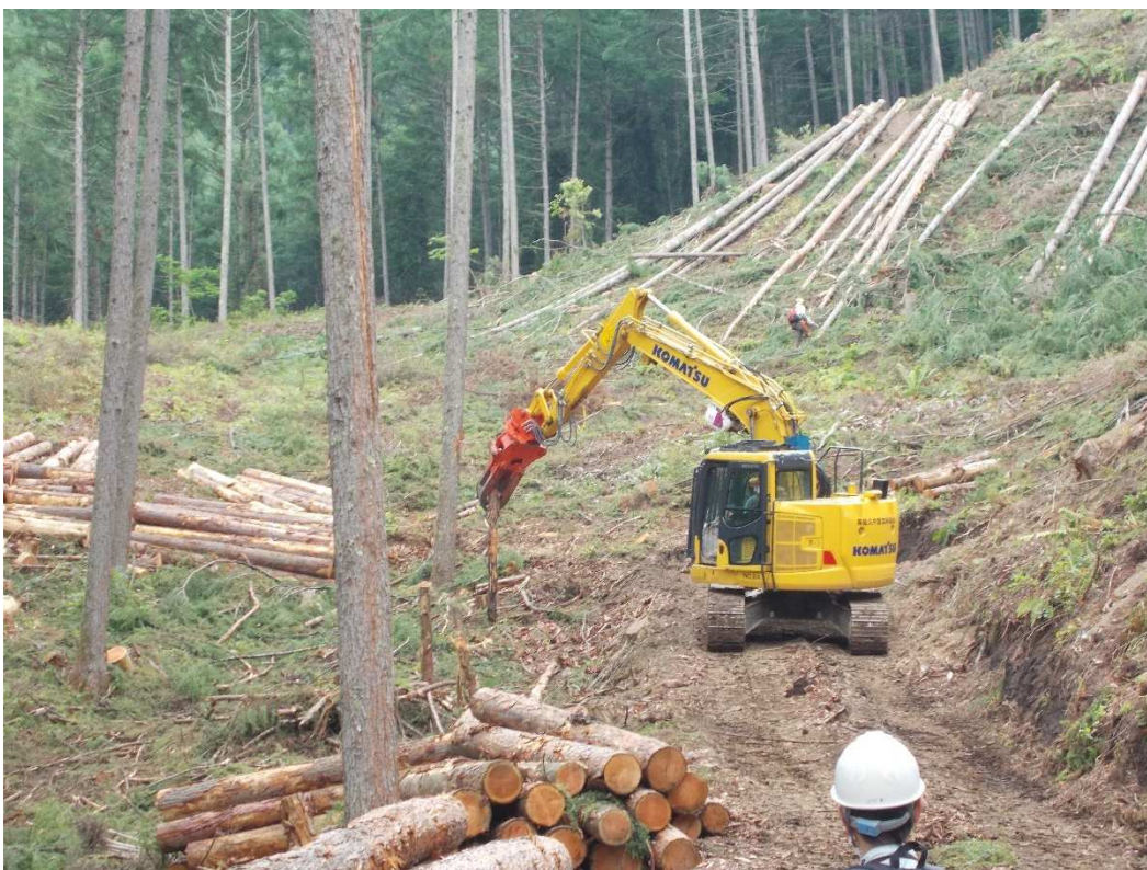
佐久穂町 カラマツ グラップル（汎用高性能林業機械）による集材状況
